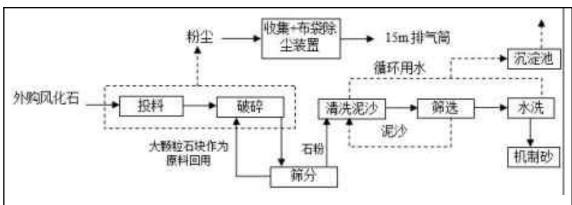
图 2 本项目工艺流程示意图
