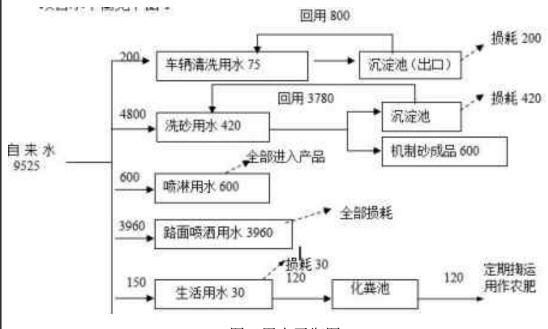
图 1 用水平衡图
